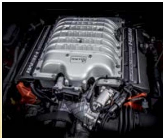
**→ Двигатель V8 HEMI объемом 6,2 л оснащен приводным нагнетателем**
